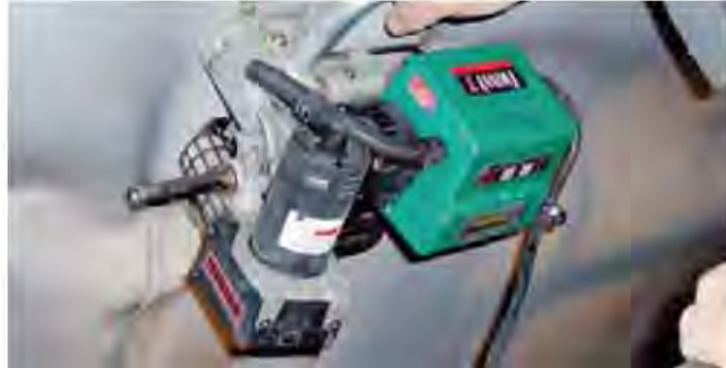
TWINNY T, sa ukrštenom drškom, priilikom izrade tunela.
