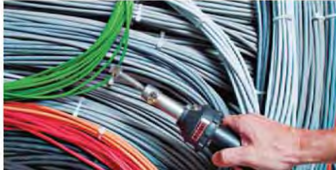
Pasovanje lema upotrebom HOT JET S sa reflektor diznom na navlačenje
