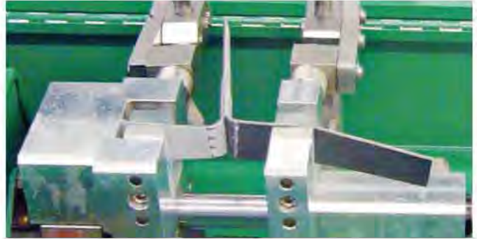
Ispitivanje vara upotrebom EXAMO USB
