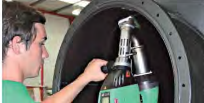
Lako se zavaruju i unutrašnji radijusi.
