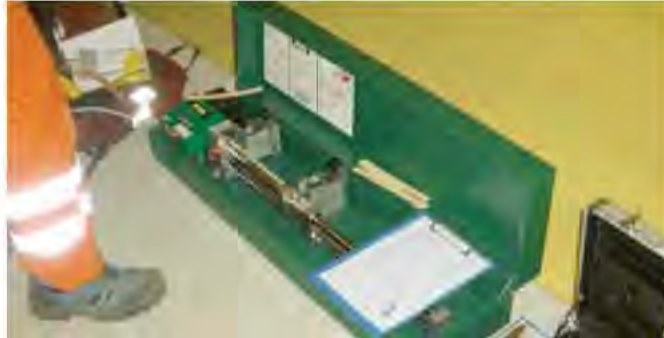
Ispitivanje vara se može obaviti u priručnoj laboratoriji EXAMO USB.
