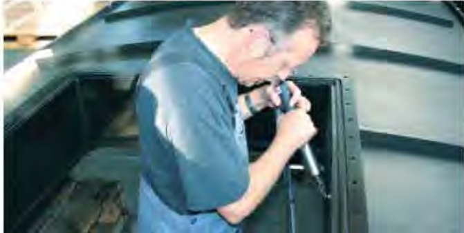
Zavarivanje PE kontejnera upotrebom DIODE PID.
