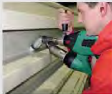
45° ugaoni adapter za WELDPLAST S2 olakšava zavarivanje u teškim pozicijama (prateća oprema)
