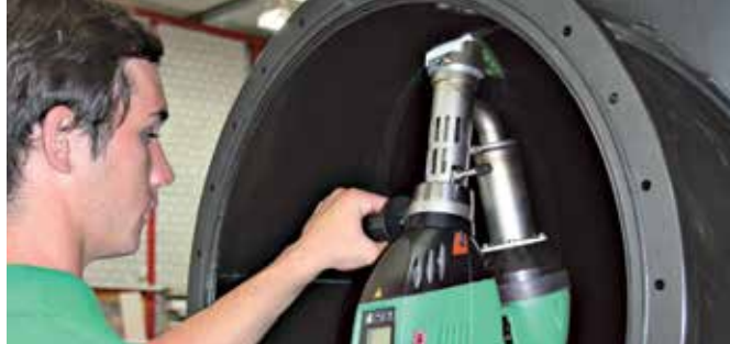
Lako se zavaruju i unutrašnji radijusi.
