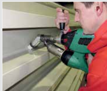
45° ugaoni adapter za WELDPLAST S2 olakšava zavarivanje u teškim pozicijama (prateća oprema)
